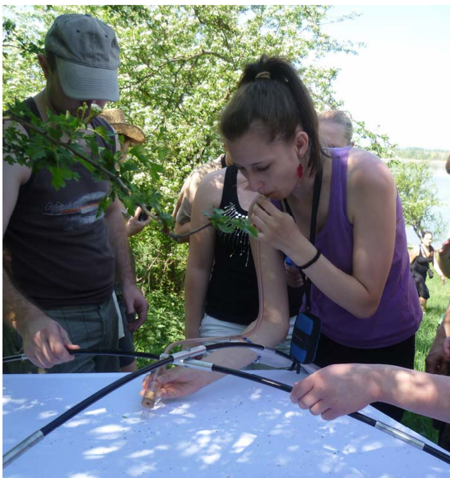
Obr. 2: Odběr vzorků ze sklepvádla pomocí exhaustoru. Foto L. Fusek.
